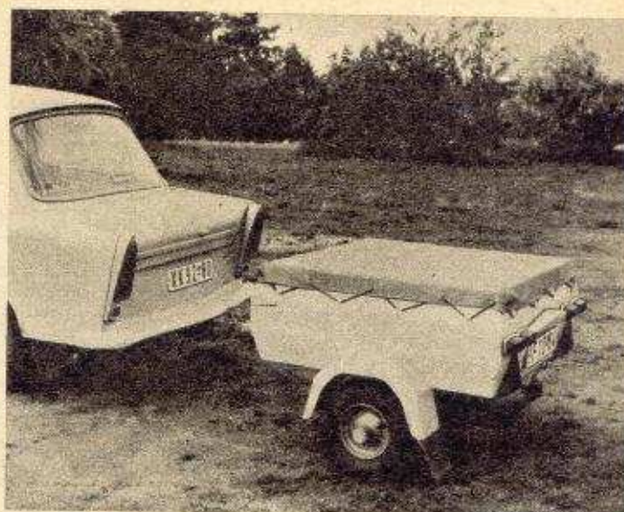
Der kleine Transportanhänger ist auch voll belastet hinter dem Trabant kaum zu spüren. Bei zulässigen 80 km/h sind noch ausreichend Leistungsreserven vorhanden.
